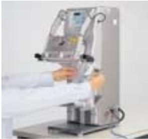
CV-300シリーズは、マイコンコントロールでシール時間制御を行います。連続運転、エアペダル操作が選べます。シール部角度が下向きの垂直型で耐腐食性ボディを採用していますので、水物や粉末の包装に最適です。テーブル高さや袋の大きさに合わせて可変できます。
