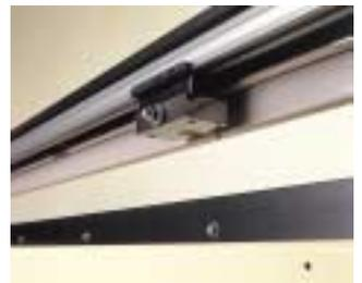
ATシリーズには機種バリエーションとしてエア圧力駆動のカッター機構を取り付けたATCシリーズがあります。ATCシリーズはシールの後で自動的に袋をカット、連続的にシール・フィルム製袋加工ができます。
