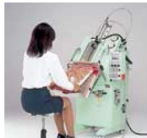
FKG-400シリーズは、シール部中央に出てくる、ノズルを袋内に挿入して、レバーで袋とノズルを挟み込んだ状態で脱気及びガス充填を行います。2重構造の特殊ノズルを搭載し、高置換率を達成できます。
