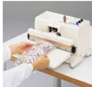
V-300シリーズは、シール部中央に出てくる、ノズルを袋内に挿入して、レバーで袋とノズルを挟み込んだ状態で脱気します。脱気終了後は、空気が逆流しないようにすばやく、もう一段階テーブルを押し下げて、シールを行います。
