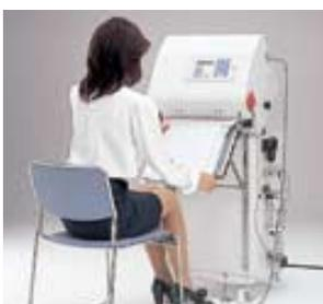
VGシリーズは、シール部中央に出てくるノズルを袋内に挿入して、レバーで袋とノズルを挟み込んだ状態で脱気及びガス充填を行います。機械頭部の操作パネルで、脱気、ガス充填方法などの諸設定を行います。写真は、頭部を40°傾斜させた状態での作業の一例です。
