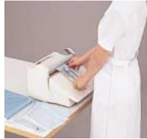
RA-250はテーブルスイッチ操作ではテーブルを押さえた時、また連続運転では設定時間の間隔でローラーが手前へ移動してきてシールを行います。滅菌バックの包装など医療機関連での利用例が増加しています。
