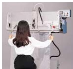
FIL-NT/NTWシリーズは、シール部中央に出てくる、ノズルを袋内に挿入して、レバーで袋とノズルを挟み込んだ状態で脱気します。写真は、大きな袋を一人の作業で、シワ無くシールできるように、オプションのテンションアームを使用しています。
