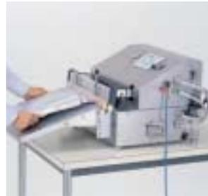
V-401NTWシリーズは、シール部中央に出てくる、ノズルを袋内に挿入して、レバーで袋とノズルを挟み込んだ状態で脱気します。オールアルミのボディとイジェクター脱気方式で、液体を含む内容物や粉末の脱気包装に適しています。
